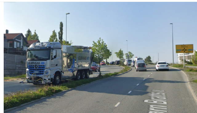
Eksempel på 1,5 meter bred rabatt i Torbjørn Bratts veg. Kun små trær vil få plass i rabatten og vil i tillegg lett skades av større lastebiler. Foto: Google Streetview
