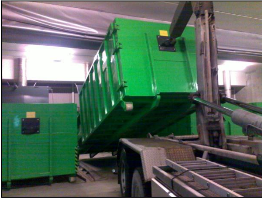
Figur 25: Renovasjonsbil stasjonært avfallsug
