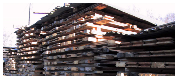
Grovt rivingsvirke ble tidligere omdimensjonert på ReBygg. I dag selger de ferdigrenset trevirke, men uten at det bearbeides maskinelt.
