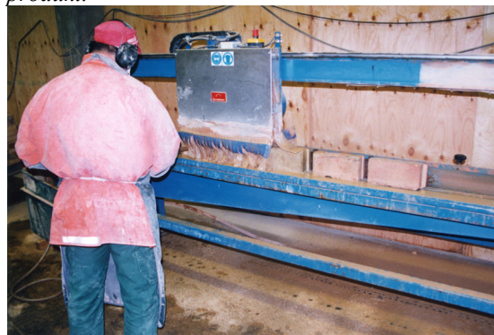
Svensk maskin med diamantblad for saging av teglstein til golv og veggflis. Ved Malmö Återbyggerdepå i Syd-Sverige er dette et populært gjenbruksprodukt.
