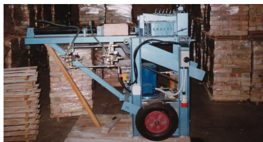
Etter å ha prøvd den hydrauliske teglrensemaskinen var konklusjonen at manuell rensing fungerte best. Rensemaskinen er produsert av Komserv i Halmstad. Den veier 225 kg og har en kapasitet på opptil 400 murstein i timen med 3 mann i arbeid. Den renser bare teglstein som er murt med kalkmørtel.
