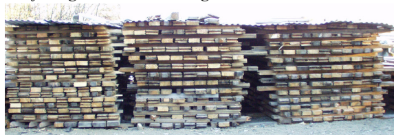
Laftaplanken fra Rye ble lagret på ReBygg før den ble sagt om til bl.a. ytterpanel på Gjenbrukshuset.
