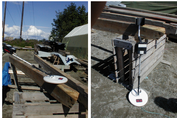
Metalldetektoren er et nødvendig verktøy for å forebygge skader på maskiner og utstyr fra skjult metall i gammelt trevirke.
