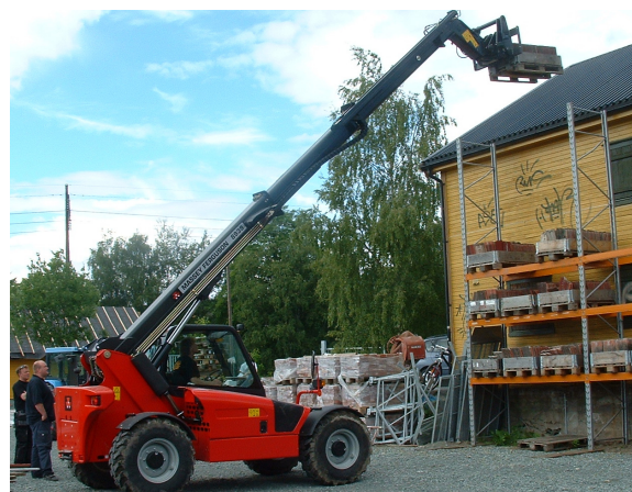
Teleskopliften som har en løftehøyde på 10 meter kan utstyres med personalkurv for takarbeid.
