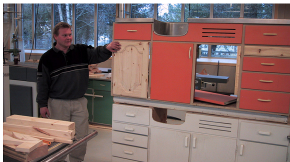
Istandsetting av kjøkkeninnredningene. ble gjort på Stavne Gård sitt snekkerverksted. Arbeidsleder Svein Erik Graadal gjorde også forsøk med å oppgradere innredninger med nye heltredører.
