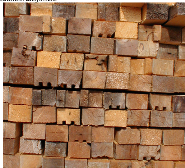
Gjenbruksmaterialer til utlekting stablet på byggeplassen. Disse materialene er laget av gammel laftaplank som ble omdimensjonert på Stavne Gård sin bruksentral ReBygg.
