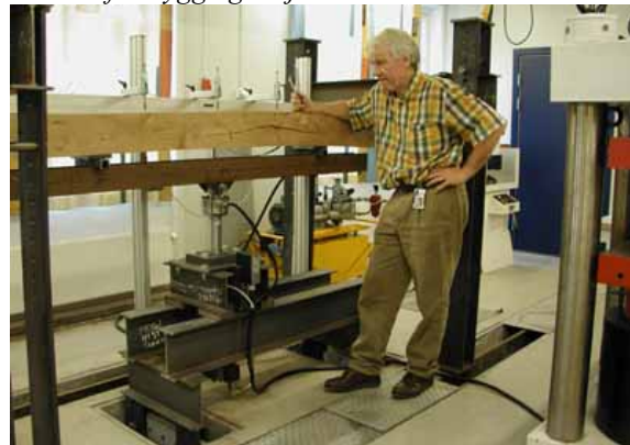
Olav Aarhaug overvåker forløpet i en belastningstest på gammelt trevirke.
