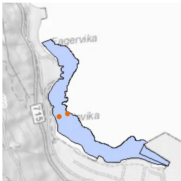
Figur 8 Målestasjoner for passive prøvetakere i Ilsvika. Plassert i med ulik avstand fra utløp fra Killingdal. En stasjon umiddelbart utenfor utløpet fra Killingdal og én stasjon lengre ut. Det settes DGT i to nivå i vannsøylen i de to prøvepunktene.
