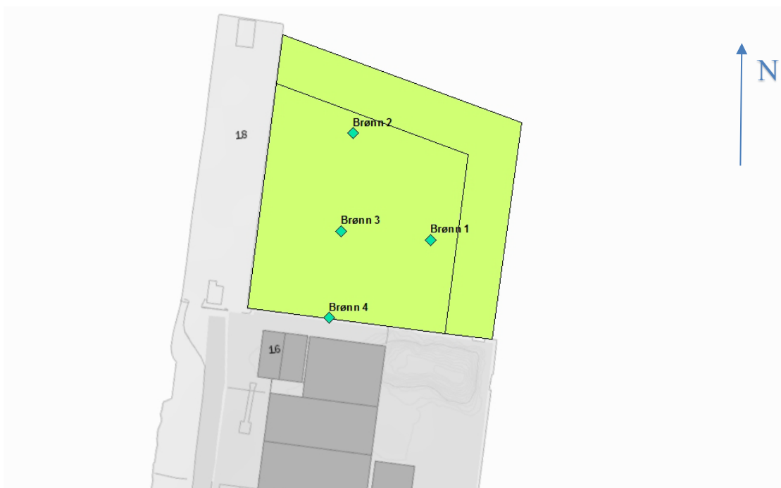
Figur 2 Grunnvannsbrønner etablert i strandkantdeponi i Nyhavna. Figuren viser øvre kant og skråning ned til bunn av sjetéer i nord og øst.
