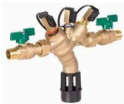
Figur 3 Kategori 4 Eksempel på type BA. Komplett med ventiler og sil. Vannets strømretning er fra venstre mot høyre
