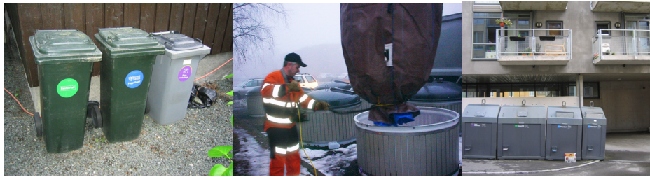
Figur 2-2. Oppsamlingsløsninger for henting av avfall fra husholdninger i Trondheim. Fra venstre: Beholderløsning i småhusbebyggelse, nedgravde containere ved blokkbebyggelse og bunntømte containere ved blokkbebyggelse. (Foto: Rambøll)
