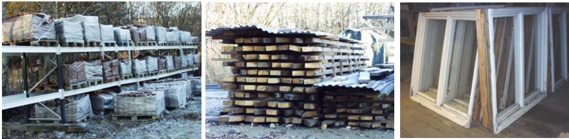
Bilde : takstein, takbjelker og vinduer fra riving Mauritz Hansen gt på lager OAS .
