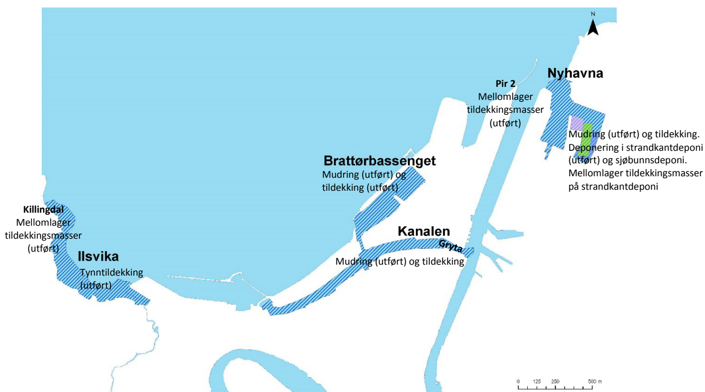
Figur 1 Tiltaksområder med planlagte tiltak i Trondheim havn vist med blå skravur; Ilsvika, Kanalen, Brattørbassenget og Nyhavna. I Nyhavna er strandkantdeponi vist med lilla farge. Sjøbunnsdeponier er vist med hhv. grønn og mørk blå farge. Mellomlager for tildekkingsmasser på Pir 2 og Killingdal-kaia er vist.
