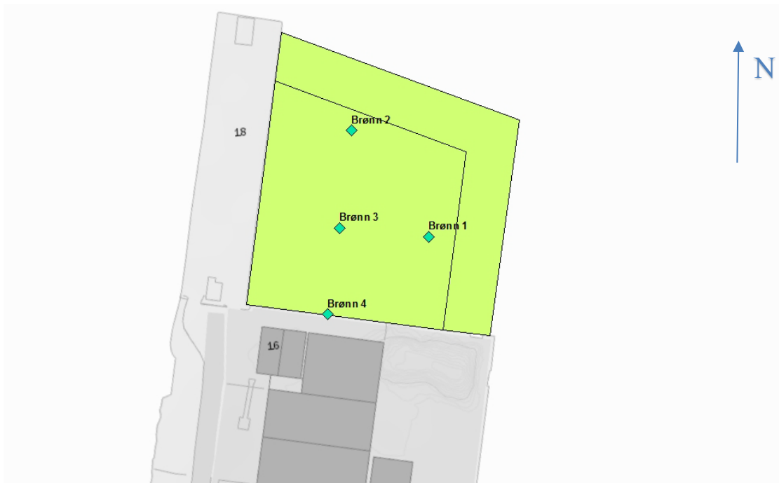
Figur 1 Grunnvannsbrønner etablert i strandkantdeponi i Nyhavna. Figuren viser øvre kant og skråning ned til bunn av sjetéer i nord og øst.
