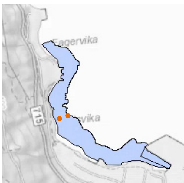
Figur 5 Målestasjoner for passive prøvetakere i Ilsvika. Plassert i transekt fra utløp fra Killingdal. En stasjon umiddelbart utenfor utløpet fra Killingdal og én stasjon lengre ut. DGTer er satt ut i to nivå i hvert av prøvepunktene.
