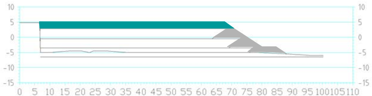
Figur 3: Sjetéer / steinfyllinger for avgrensning av sjøbunnsdeponi og strandkantdeponi. Grått viser sjetéer og grønt viser lag med rene masser oppå deponi.
